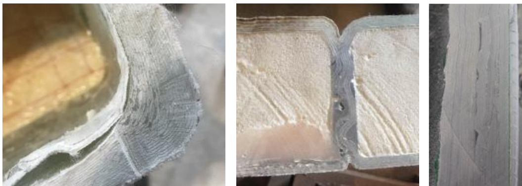
Figuur 8: Foto's van enkele imperfecties vastgesteld door RR in afgewerkte producten (cf. slides 34 en 35 van Bijlage C)
