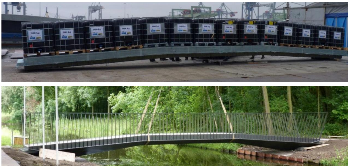
Figuur 6: Voorbeeld van een belastingsproef uitgevoerd op een brugdek in de fabriek (cf. slide 39 uit Bijlage A)
